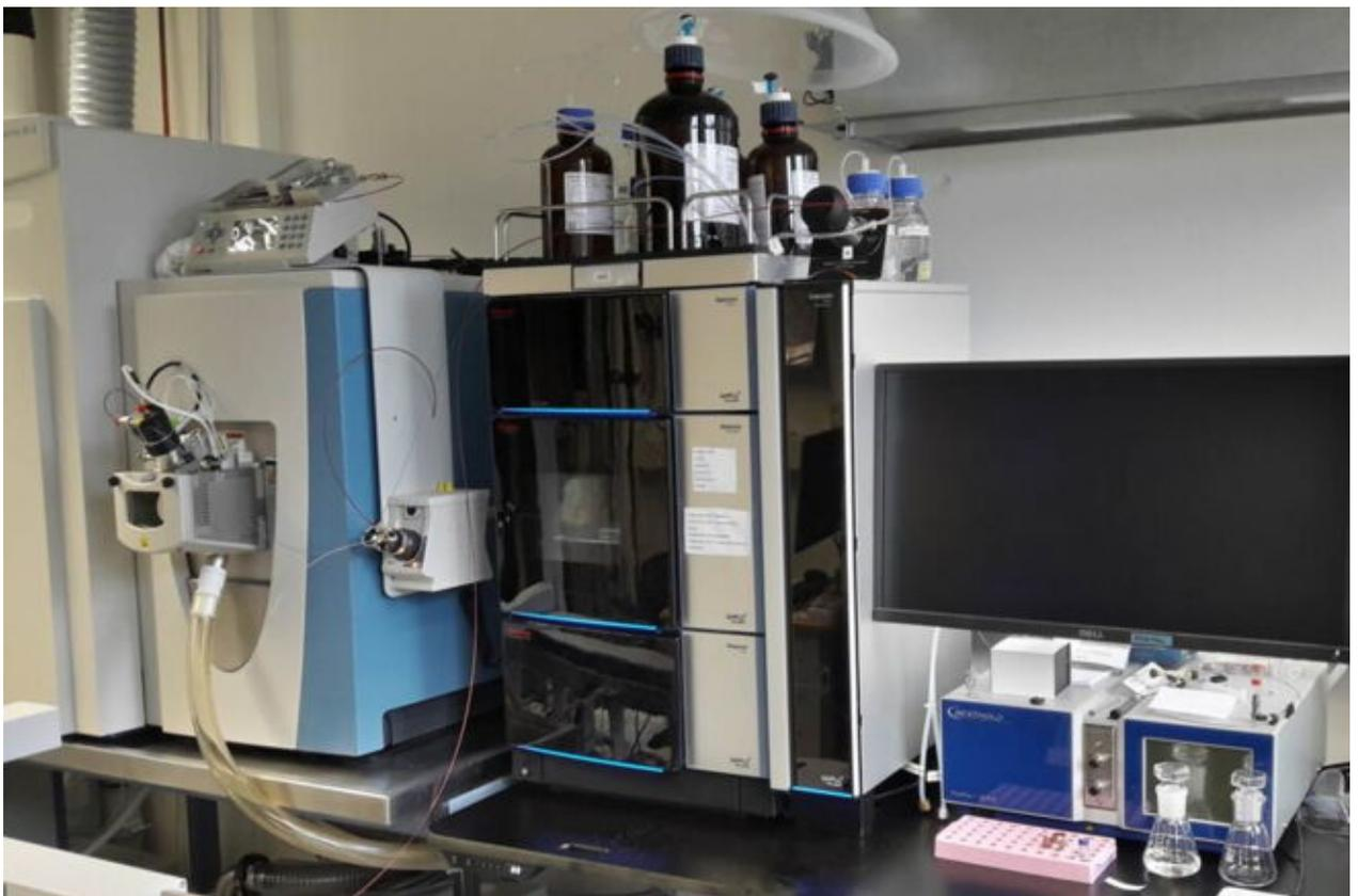
— Thermo Q-Exactive HF-X HR(AM)MS mit Thermo Vanquish Horizon UHPLC mit Berthold FlowStar LB 514
