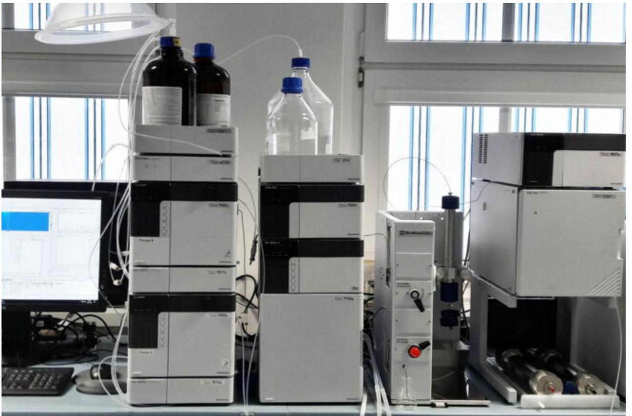
\_ Shimadzu präparative HPLC (LC20-Pumpen) mit DAD, ESLD und Fraktionssammler
